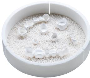
1. Befüllen Sie die Sinterschale mit einer ganzen Flasche Sinterperlen für ZrO<sub>2</sub> (REF 6126457).
