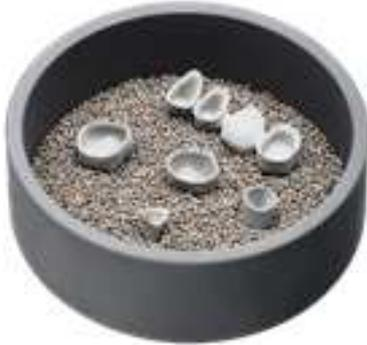
1. Befüllen Sie die Sintermetallschale mit einer ganzen Flasche Sinterperlen für Sintermetall (REF 6413640).
