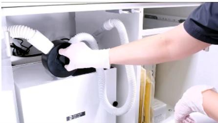
2. Drehen Sie den schwarzen Adapter des Set-Handreinigungsschlauchs vom Ansaugen der Kammer zum Ansaugen durch den Handreinigungsschlauch.
