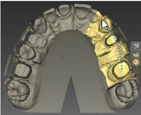
7. Markieren Sie die Bereiche, die mit höherer Präzision gescannt werden sollen, indem Sie die linke Maustaste gedrückt halten und über den jeweiligen Bereich ziehen. Drücken Sie anschließend die grüne Schaltfläche "Scan".
