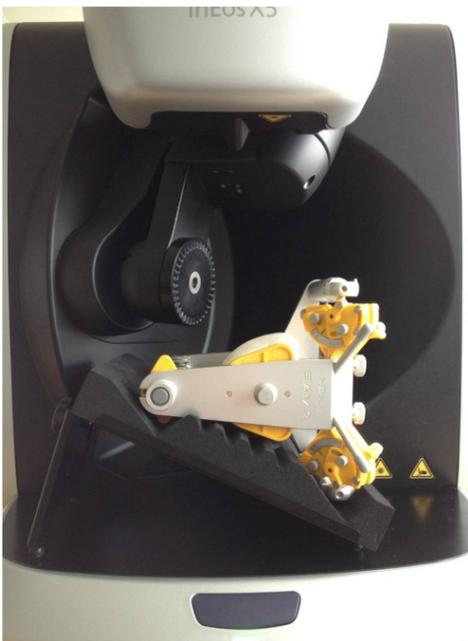
2. Platzieren Sie die Artikulatorplatte im Arbeitsbereich des inEos X5 so, dass die bukkale Aufnahme erfasst werden kann.
