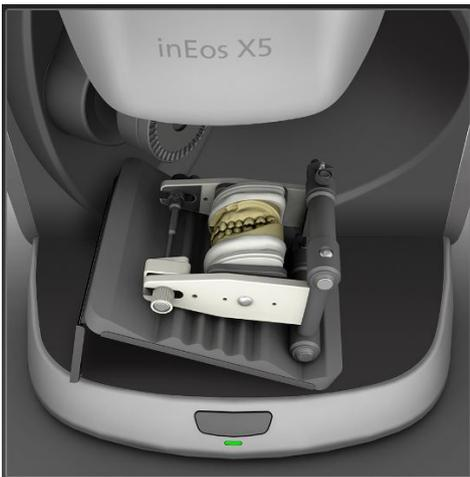
11. Platzieren Sie die Modelle mit Ober- und Unterkiefer im Scanner und starten Sie die bukkale Aufnahme, indem Sie die grüne Schaltfläche "Scan" drücken.
