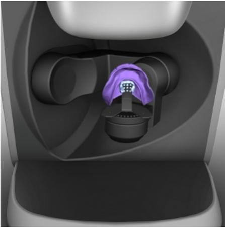
9. Wählen Sie *"Bisswall"* in der Objektliste aus und positionieren Sie das Modell mit Bisswall so auf dem Prothesen-Halter, wie Hinweisbild und Text es vorgeben.
