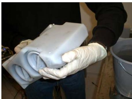
4. Verschließen Sie die Ablauföffnung (D) mit dem Daumen und schwenken Sie den Tank erneut 5x kräftig in kreisförmigen Bewegungen.
