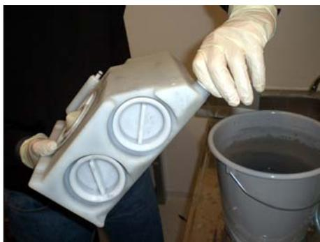
3. Öffnen Sie die Ablauföffnung (D). Kippen Sie den Tank dabei soweit, dass keine Flüssigkeit aus der Ablauföffnung austritt.
