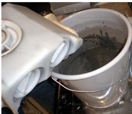
5. Entleeren Sie den Tank um ca. 1/3 des Inhalts in den bereitgestellten Auffangbehälter. Ein zusätzliches Betätigen der federbelasteten Einlassöffnung des Tankdeckels (B) erleichtert das Ausgießen.
