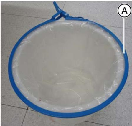
3. Setzen Sie den Spannring auf den externen Tank mit der Beschriftung (A) nach oben.
